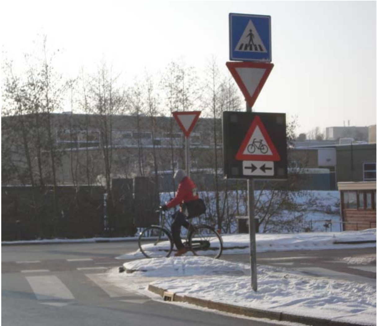
Figuur 7. Passief bord dat waarschuwt voor fietsers uit twee richtingen
