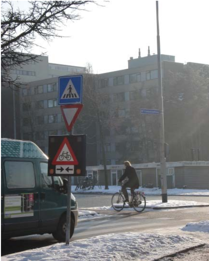
Figuur 8. Actief bord (geactiveerd bij nadering fietser)
